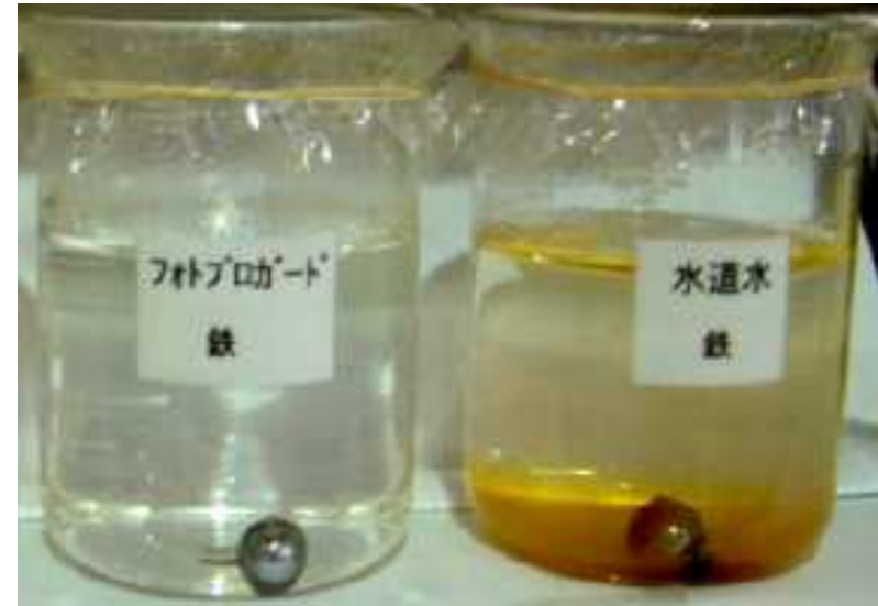
455日経過後の腐食状態
